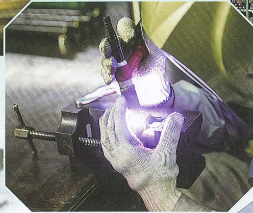
溶接作業（チタン魔術師） チタン製品に不可欠な 高度な溶接技術をもつ 熟練技能者が対応
